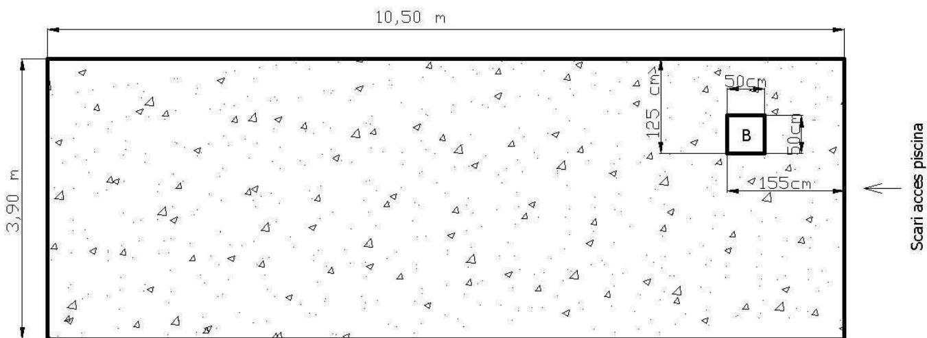
Grosimea placii de beton va fi de 15 cm, simplu armata
