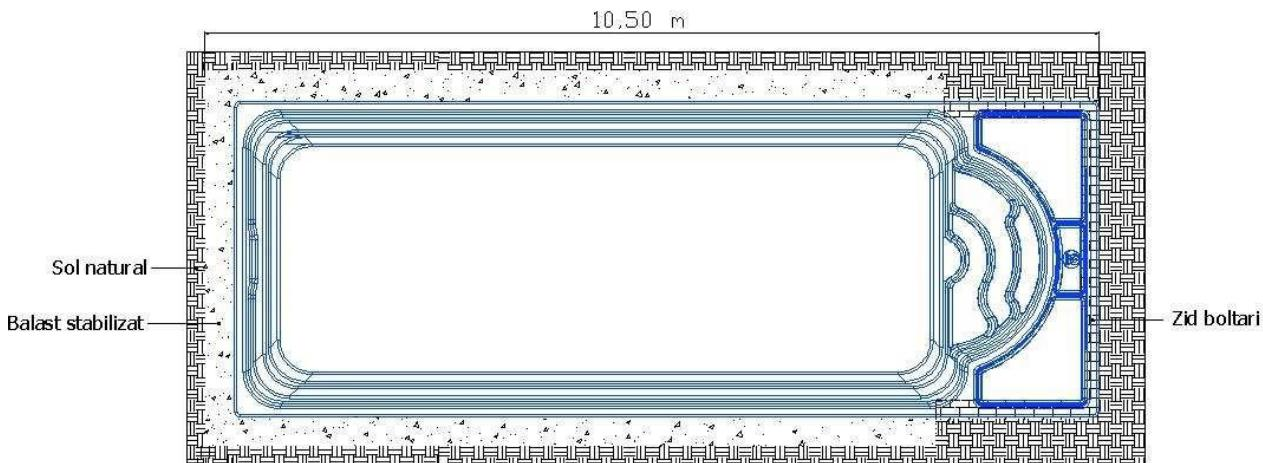
**De jur imprejurul piscinei si pe toata adancimea ei se va pune balast stabilizat. Pentru piscina ROMA MAXIMA 10,2x3,6x1,5 m sunt necesari aprox. 14 mc balast cu granulatia 0-16 mm (balast si nisip). Pentru fiecare 1 mc de balast se adauga 160 kg ciment.**
